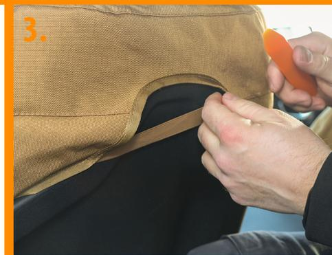
**3.** Das Gummiband des Bezugs unter die Kunststoffverkleidung auf der Rückseite des Sitzes einschieben.
