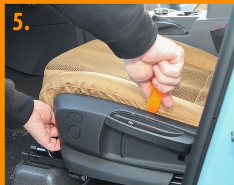
**5.** Ebenso bei der Sitzfläche verfahren. Die Schaumstoffleiste des Bezugs zwischen Sitzfläche und Rückenlehne schieben, bis das angenähte Gurtband an der Rückseite erscheint.
