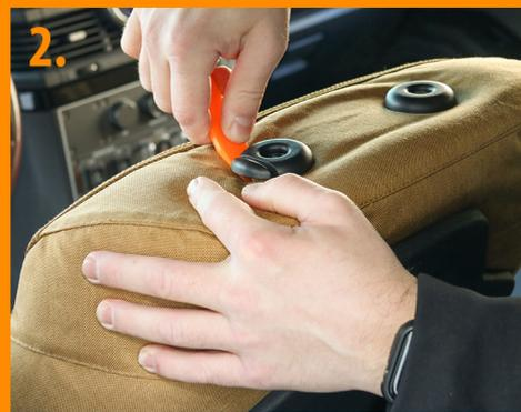
**2.** Nach dem Überstülpen des Bezugs über den Sitz, den Stoff um die Verkleidung der Kopfstützöffnung mit dem mitgelieferten Werkzeug einschieben.
