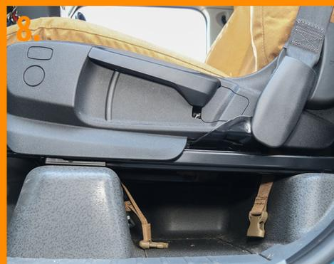
**8.** Beide Steckschließen an der Unterseite des Sitzes verschließen.
