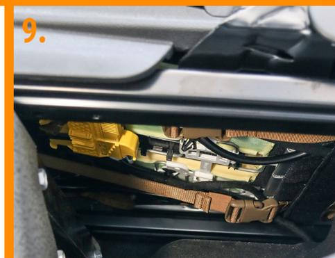
**9.** Ansicht Unterseite des Sitzes mit geschlossenen Steckschließen. Das Gurtband kann nach Bedarf festgezogen werden.
