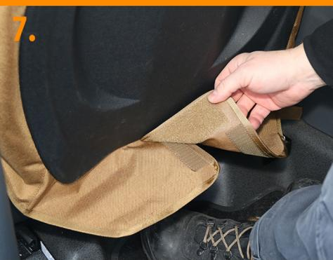
**7.** Die Unterseite des Bezugs mit dem Klettverschluss verschließen und am Sitz befestigen.
