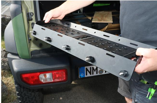
**Als erstes werden die Seitenteile und das flache Blech am Fahrzeug angeschraubt.**
