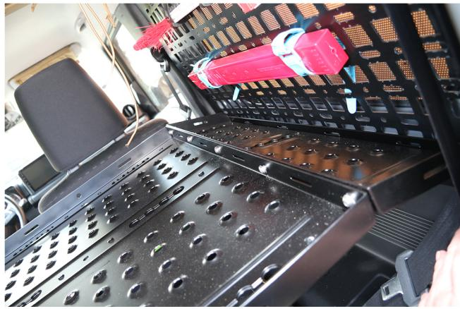
**Die Schrauben bitte noch nicht final festziehen, die Seitenteile sollen sich noch bewegen lassen. Wenn beide Seitenteile angeschraubt wurden kann man das Ablageblech dazwischen schrauben, also die kurzen Schrauben einfädeln, Unterlegscheiben nicht vergessen, Stopmuttern draufdrehen und fest anziehen. Zum Schluss dann die Schrauben der Seitenteile fest anziehen, FERTIG!**
